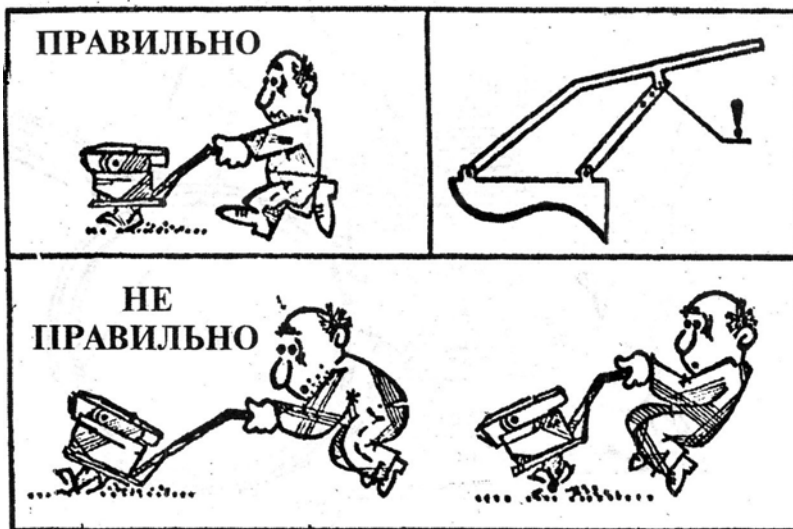
Рис. 10. Регулировка высоты руля.
