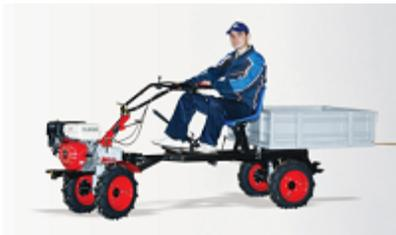
Адаптер предназначен для работы совместно с мотоблоком НМБ-1Н Угра. Он оснащен удобным сиденьем, тормозной системой ленточного типа, съемным кузовом, прицепным механизмом для навески агрегатов.
