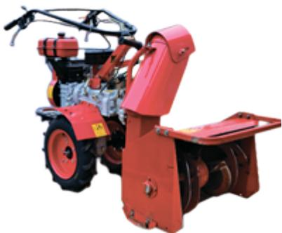
При работе с мотоблоком Угра НМБ-1 и его модификациями привод снегоуборщика осуществляется через редуктор шестеренчатый от вала отбора мощности двигателя.
