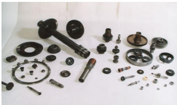
**Цилиндрические шестерни** наружного и внутреннего зацепления с нормальным эвольвентным и модифицированным профилем, прямозубые и косозубые с модулем 1-10 мм, числом зубьев  $Z=8$  и выше, шероховатостью профиля  $Ra 1,25$  мкм -  $Ra 0,16$  мкм, 4-7 степени точности с химико-термическим упрочнением профилей.
