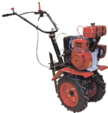
В 2010 году серия мотоблоков МБ-1 получила достойное развитие: мотоблок МБ-1ДЗ с тросовой системой управления. Новое техническое решение позволило исключить из системы управления передним и задним ходом металлические рычаги, тяги и цепочки. Система аварийной остановки двигателя встроена в акселератор, что делает отключение и остановку двигателя мгновенными. Новая рулевая колонка позволяет осуществлять разворот руля в вертикальной и горизонтальной плоскостях.
