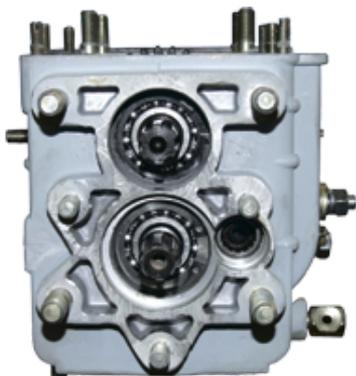
Два вала отбора мощности на коробке передач позволяют производить стационарные работы на широкой гамме навесных орудий: циркулярная пила, кормодробилка, водяной насос, земляной бур и другие.
