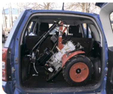
При минимальной разборке мотоблок легко помещается в багажнике любого легкового автомобиля, что значительно облегчает транспортировку. Дополнительно (по заявке потребителя) мотоблок может комплектоваться грузами для лучшего сцепления при пахоте, окучивании и т. д.
